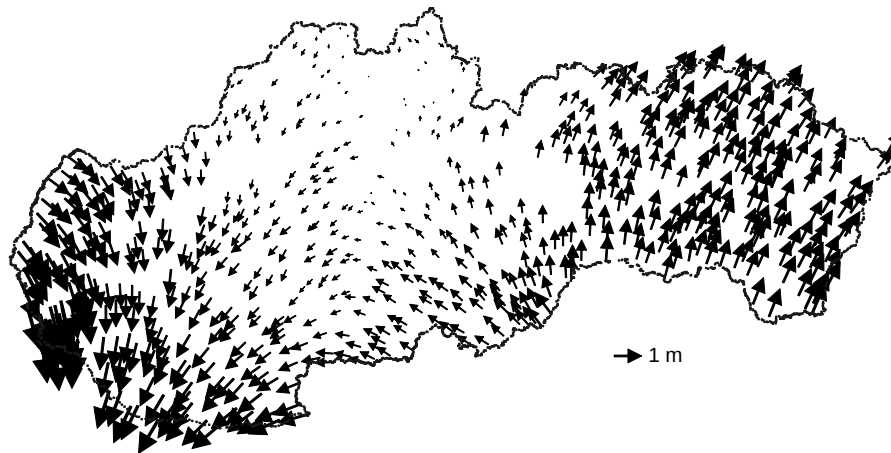
Obr.3.1 Súradnicové rozdiely medzi pôvodnou (JTSK) a novou (JTSK03) realizáciou S-JTSK na identických bodoch.
