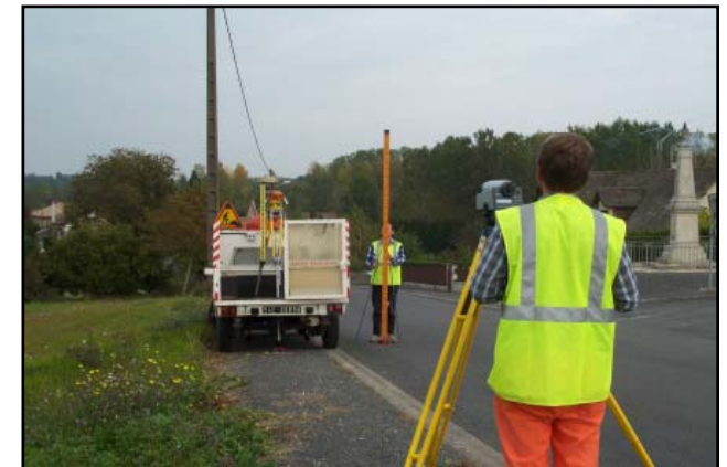
Nivellement de l'antenne
